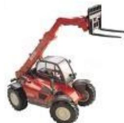
Cat. 9 : Engins de manutention (chariot élévateur de chantier ou tout terrain)
