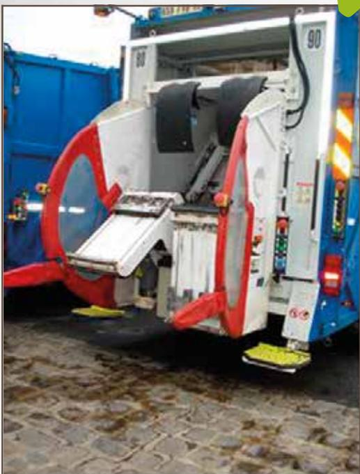
Des écrans latéraux bien dimensionnés permettent d'éviter que les ripeurs puissent accéder à la zone de manœuvre et au lève-conteneur pendant la manœuvre.
