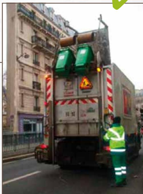
La collecte des encombrants nécessite des véhicules spéciaux avec moyen de levage.
