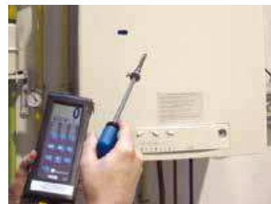
Mesure du taux de monoxyde de carbone dans l'air ambiant à proximité de l'appareil en fonctionnement.
