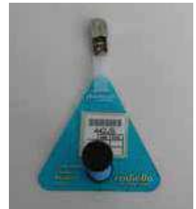
Capteur tube à diffusion pour mesure du benzène.
