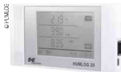
Exemple d'appareil de mesure d'humidité relative, température et CO 2 (Humlog 20 TCO de E+E).
