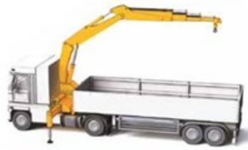
Grue de chargement montée derrière la cabine
