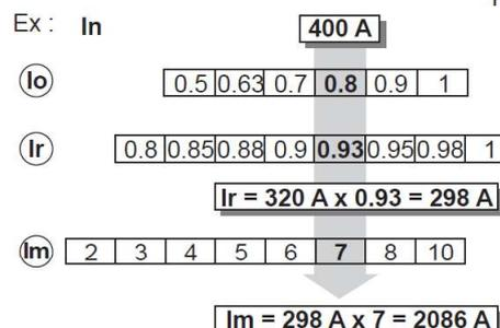
Un disjoncteur NS400 avec un TC 400 A le déclencheur STR23SE est calibré à 400 A
