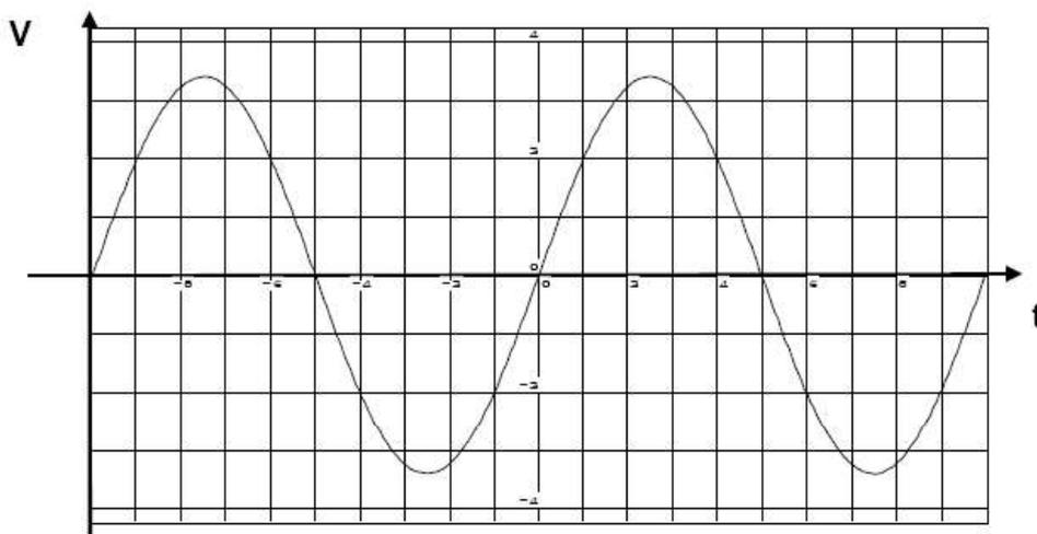
Déterminer la période, la fréquence, la valeur maximale et la valeur efficace de la tension d'entrée de l'alimentation redressée sachant que les échelles sont pour **V** : 10 V/division et pour **t** : 2 ms/division.
