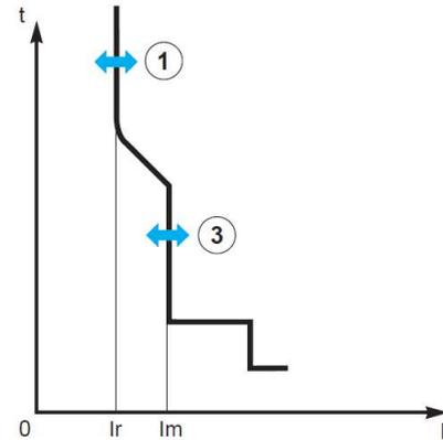
Le calibre des déclencheurs STR23SE et STR53UE est fixé par le transformateur du courant du disjoncteur.
